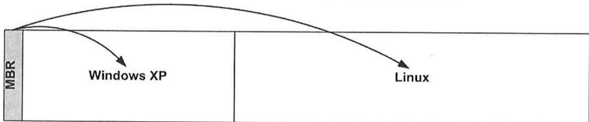
Cependant, si chaque système d'exploitation est fourni avec un ou plusieurs gestionnaires d'amorçage, ces derniers ne savent pas forcément charger tous les systèmes présents sur la machine. Lors de l'installation (ou réinstallation) de l'un d'entre eux, il est possible de perdre l'accès aux autres.
