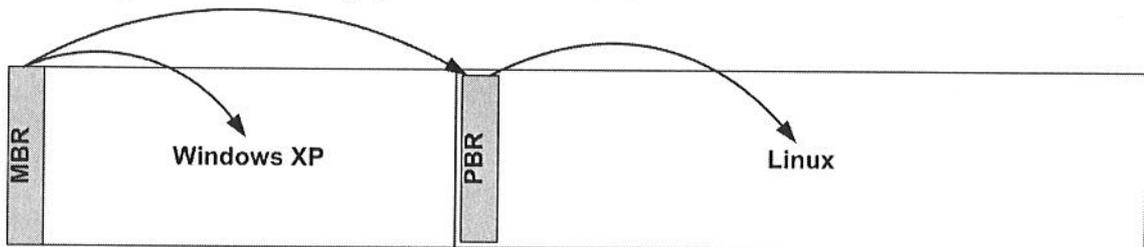
Il est possible de contourner le problème précédent et de réécrire le chargeur Linux dans le MBR en utilisant un disque de démarrage (disquette, CD-Rom ou disque USB), contenant un secteur d'amorçage et le noyau Linux, que l'on aura eu soin de créer tant que le système Debian Etch est accessible. Dans ce cas, le disque dur n'étant plus l'unité d'amorçage, il sera possible de démarrer Debian Etch et de restaurer le chargeur Linux original supprimé lors de l'installation de Windows XP.
