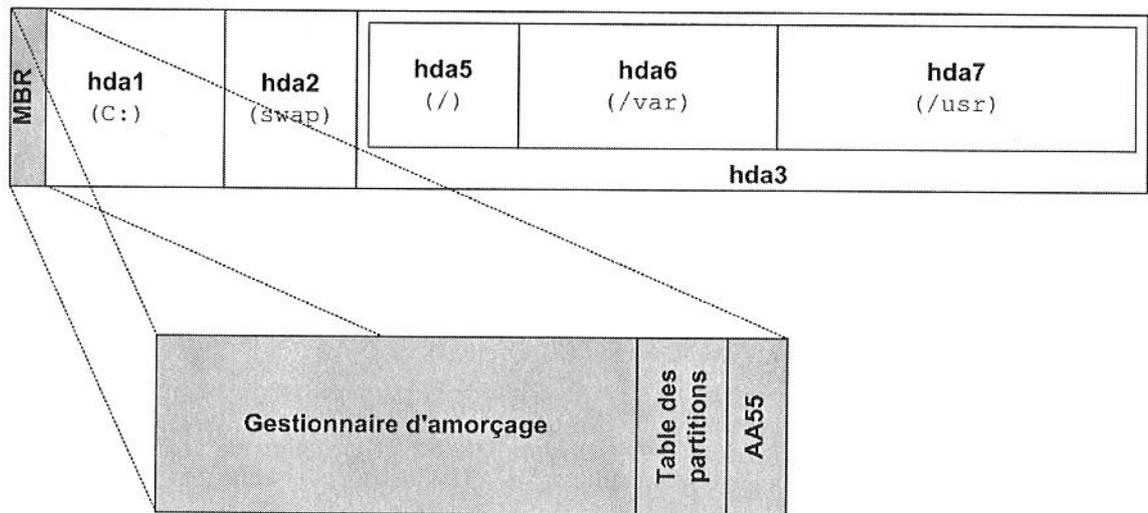
Dans le cas le plus simple, le chargeur choisit le système d'exploitation de la partition définie comme active dans la table des partitions ; c'est pour cela qu'un système DOS ne peut être installé ailleurs.
